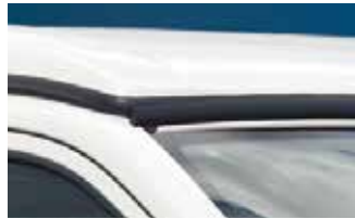
Das Schlafdach Superflach kurzer Radstand wird serienmäßig mit einem Gummi-Spoiler geliefert.
