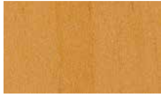
Apfel Pappelsper Holz mit 0,6 mm HPL-Beschichtung (High Pressure Laminate), beidseitig
