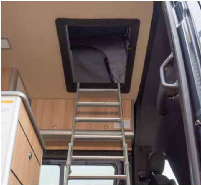
Einstiegs Luke mit Aufstiegsleiter
