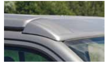
Das Schlafdach Superflach langer Radstand, vorne und hinten hoch, wird serienmäßig mit einem aerodynamischen Spoiler geliefert.
