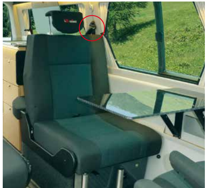
Befestigung des Gurtes am Fahrzeug-Holm
